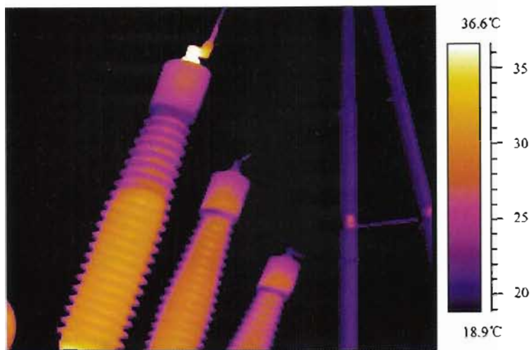
图 J. 31 变压器套管发热套管缺油及柱头发热
