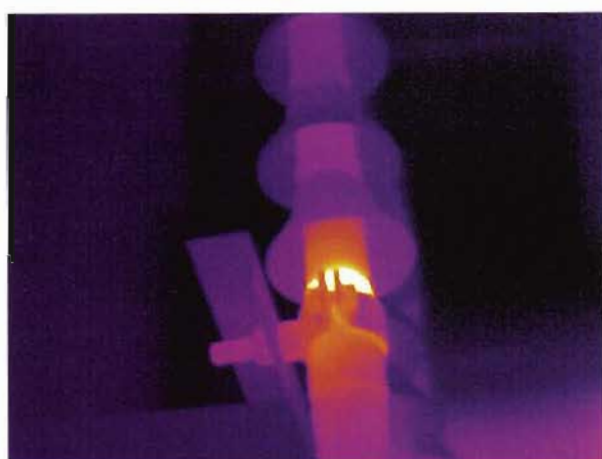
图 J. 28 35kV 交联电缆终端场强不均匀，发热
